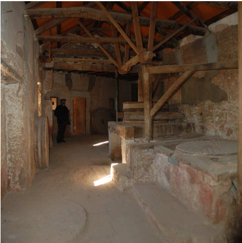
Bancada que soporta las dos piedras del molino hidráulico
